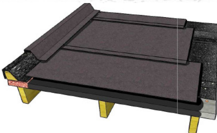
Podkladní pás celoplošně natavený
