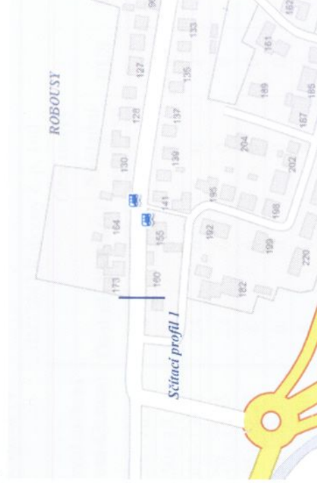
Obr. 8 Umístění profilu 1 pro sčítání intenzity dopravního proudu u měřicího místa M1
