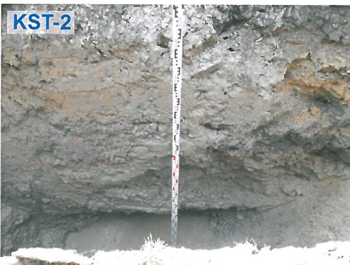
KST-2 - tentýž pohled jako výše, ovšem zahloubená do konečné hloubky do jílovitopísčitých štěrků terasy Metuje G3
