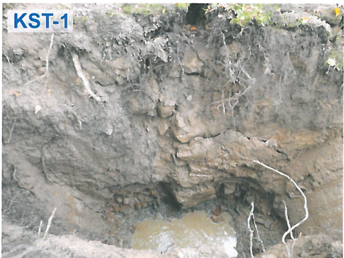
KST-1 - jihovýchodní stěna sondy; uprostřed svislý pruh pískovcových balvanů až metrových bloků - zřejmě vyplněná rýha základové spáry původního objektu, zahloubená přes povodňové sedimenty S4/F3 až na propustné limonitizované štěrky terasy Metuje G2, uložené na šedých písčitojílovitých štěrcích G5
