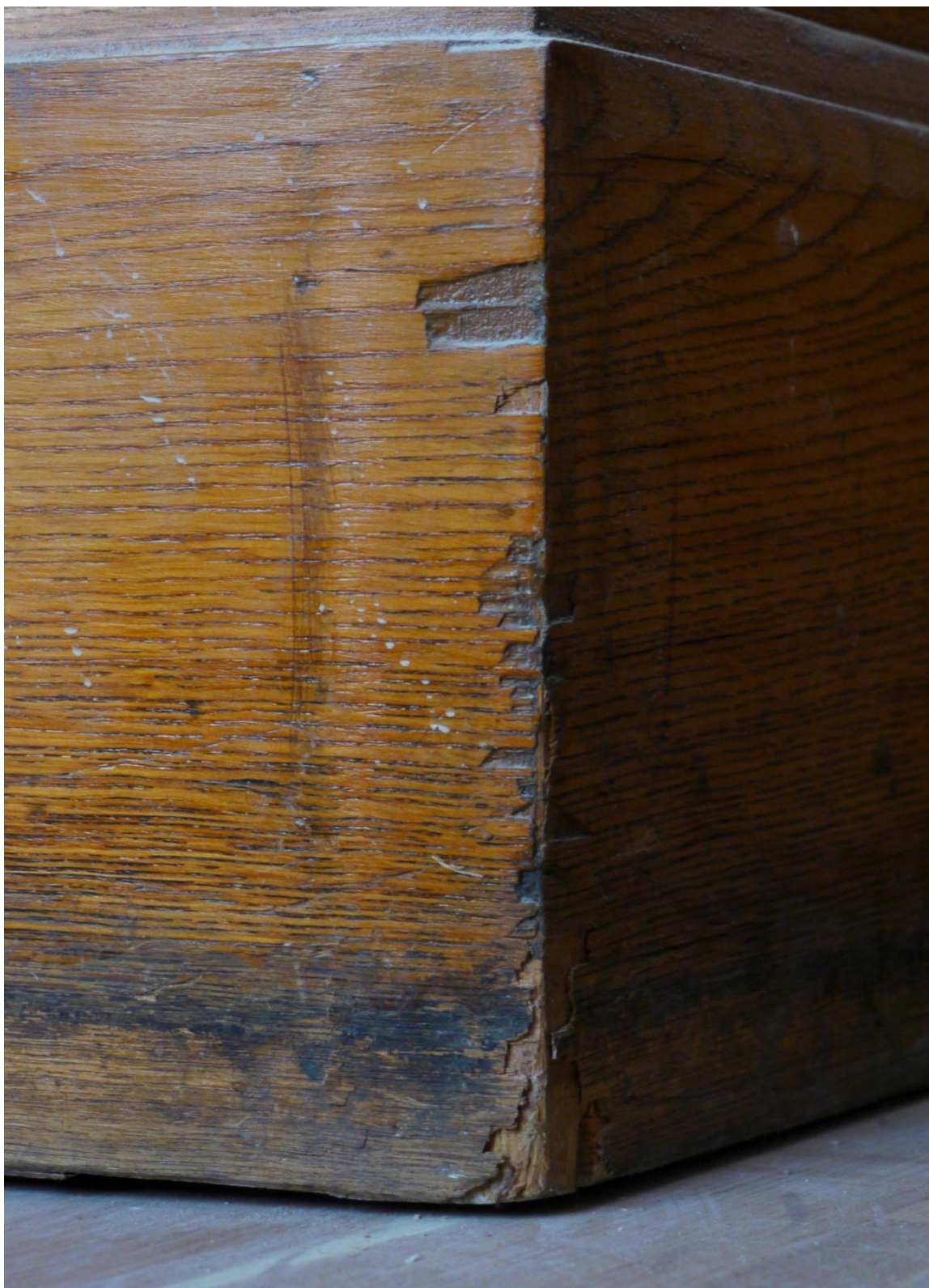
Obr. č. 5. Stav při průzkumu – skříň s policemi – detail Soklové části obou skříní jsou značně poškozené. Dýhování je oštípané, dýhy se uvolňují, část u podlahy je zčernalá.
