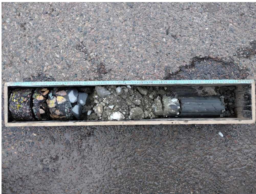
S45 – skladba konstrukce
