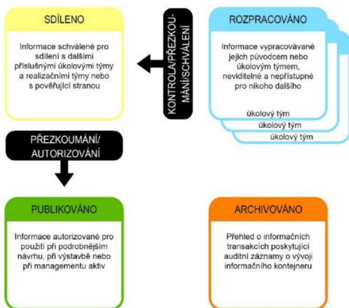
Schéma stavů informačního kontejneru (dle ČSN EN ISO 19650)
