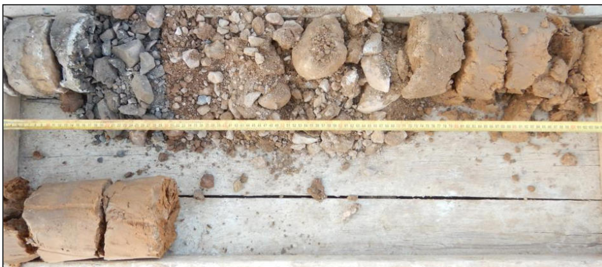
Foto 2 : charakteristický profil konstrukčních vrstev kameniva 0/63 mm, valounového štěrkopísku G3/G-F na podloží prachovitěho jílu F6/CL
