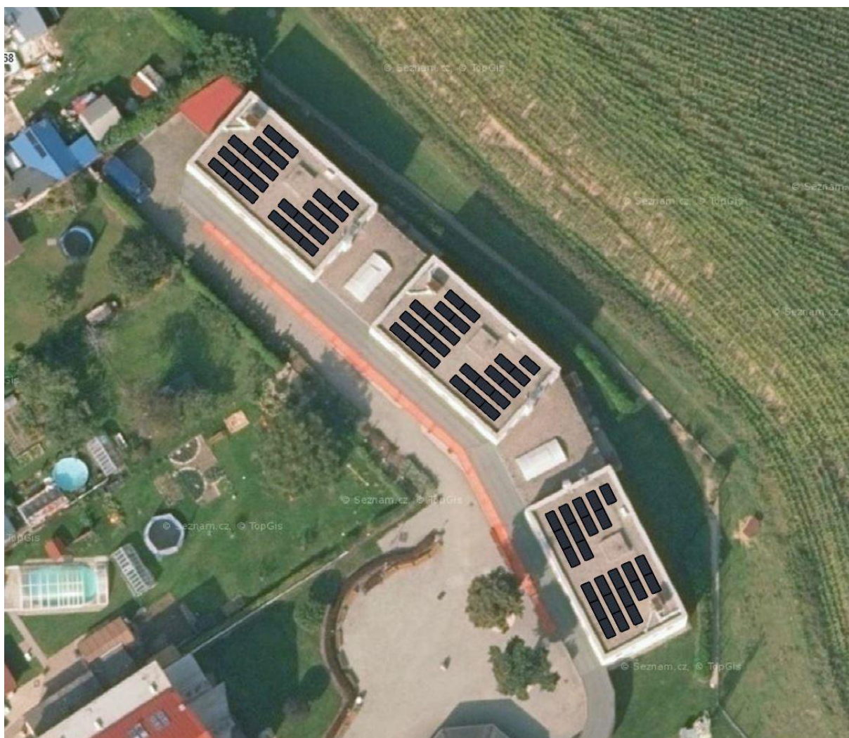
Obr. č. 3 Předpokládané rozmístění panelů na střechách
