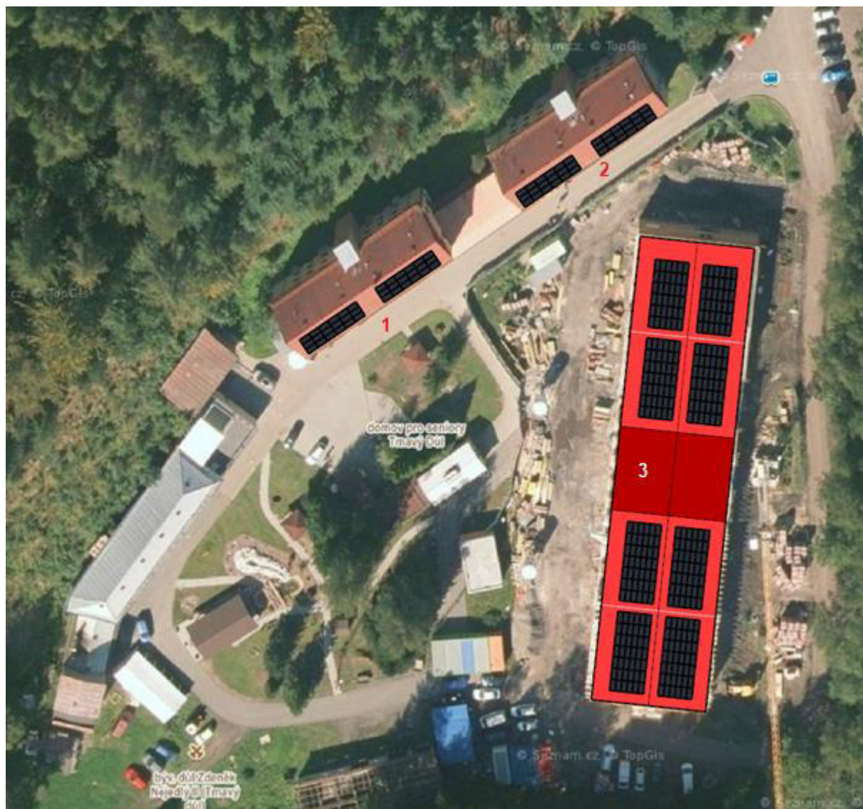
Obr. č. 3 Předpokládané rozmístění panelů na střechách
