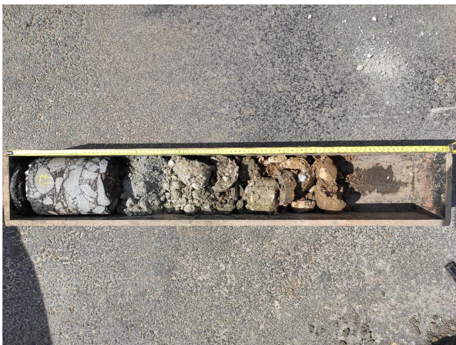
JV17 – S17 (sonda na stavbě)
