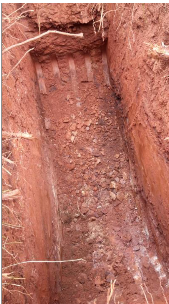
Sonda K1 - ilustrativní fotodokumentace typicky červenohnědého zbarvení permokarbonských hornin a charakter kamenitého rozpadu pískovce v hloubce od 1,5 m
