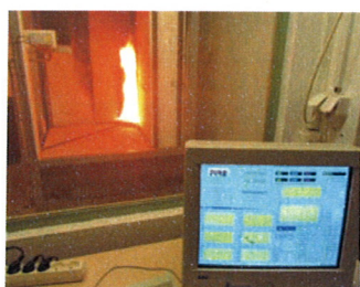
Isover TWINNER při zkoušce SBI – třída reakce na oheň B-s1,d0
