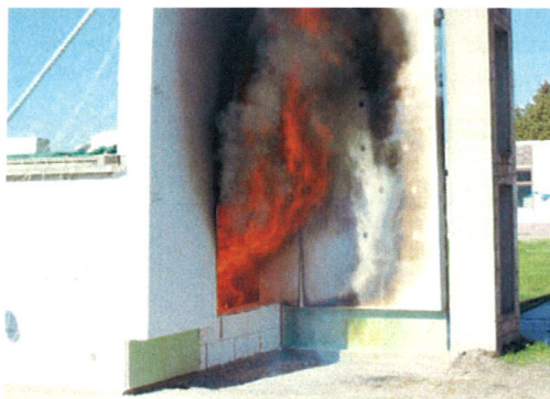
Vzorek zateplení ETICS s materiálem Isover TWINNER v průběhu a po ukončení zkoušky. Zateplení fasády zůstává celistvé a nešíří ani extrémní požár. V průběhu zkoušky nedošlo k žádnému odpadávání ani odkapávání částic zateplení.
