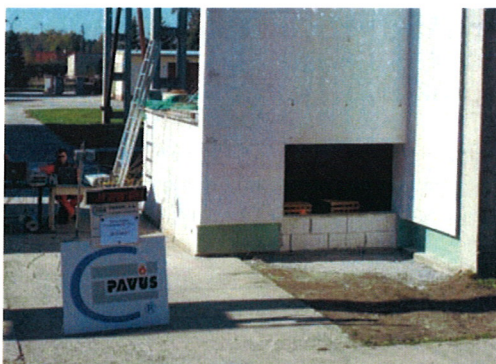
Vzorek ETICS s materiálem Isover TWINNER připravený ke zkoušce dle ISO 13 785-2. Zdrojem extrémního tepelného výkonu při zkoušce jsou normové hranice vysušeného řeziva.
