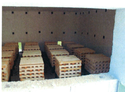
Vzorek ETICS s materiálem Isover TWINNER připravený ke zkoušce dle ISO 13 785-2. Zdrojem extrémního tepelného výkonu při zkoušce jsou normové hranice vysušeného řeziva.
