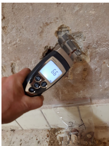
foto/11/ Místo měření vlhkosti Z1
