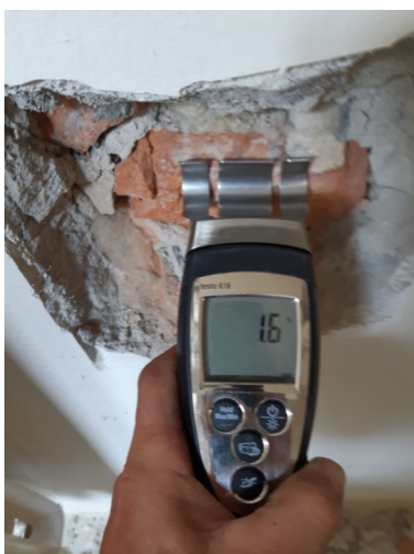
foto/17/ Místo měření vlhkosti Z3
