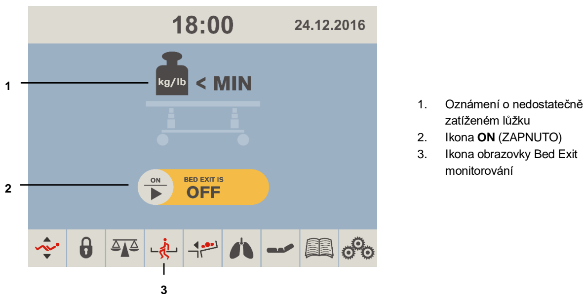
Obr. Obrazovka Bed Exit monitorování (VYPNUTO)
