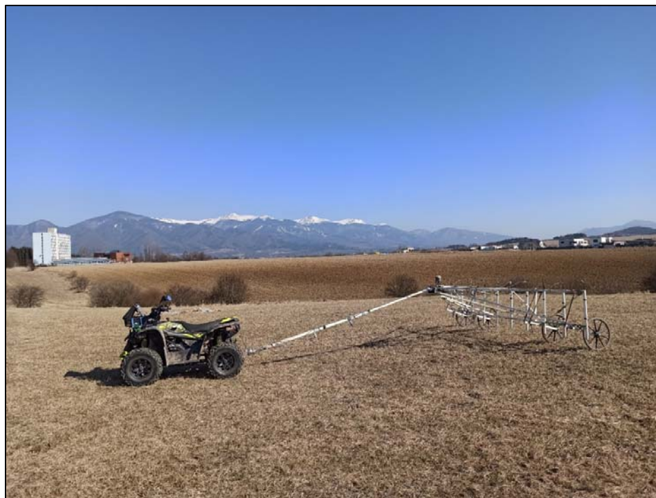
Obrázok 4: Fluxgate magnetometer LEA MAX – „ATV“ mód (Eastern Atlas, Nemecko).
