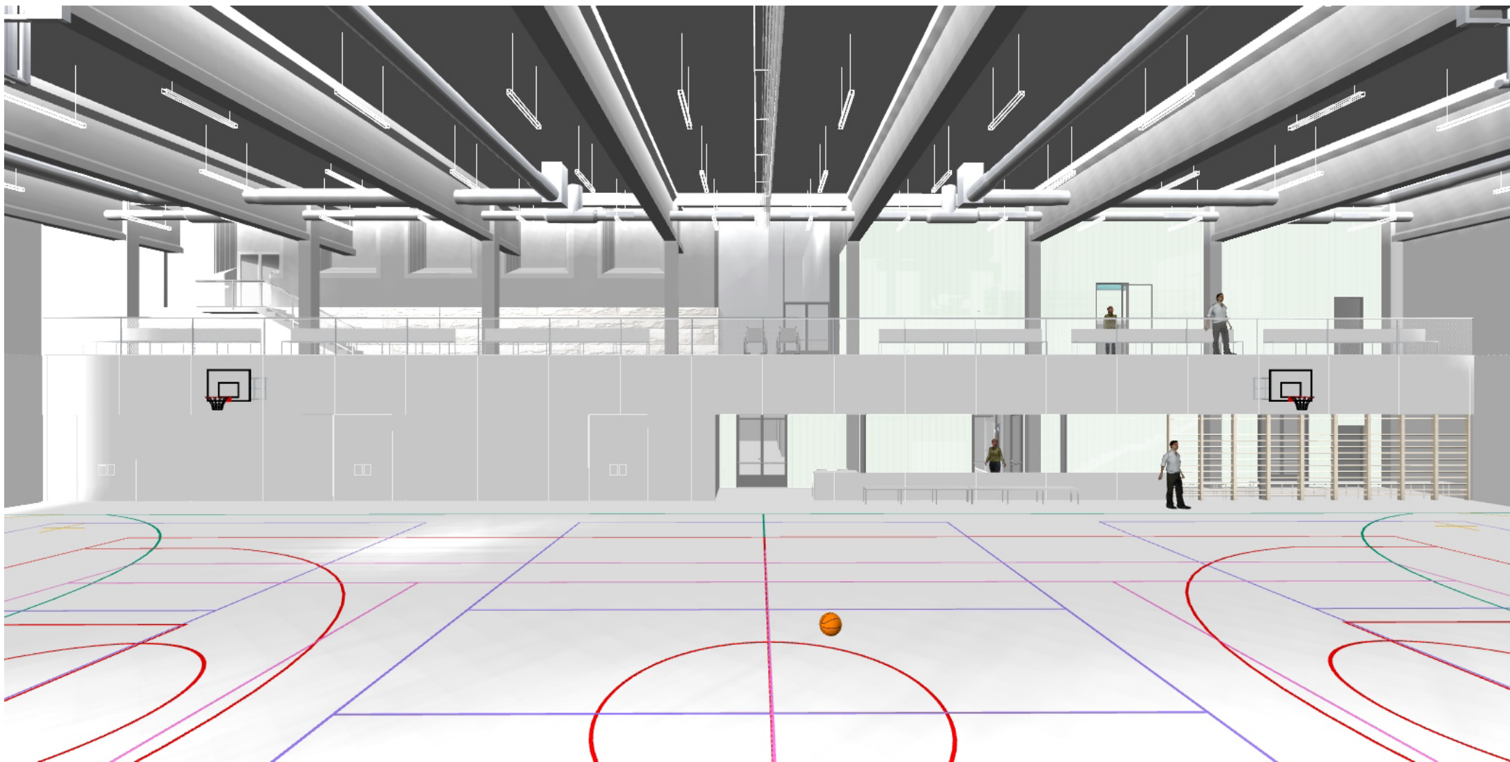
UKÁŽKA 2 TELOCVIČŇA - HALA, závesné osvetlenie medzi nosníkmi
