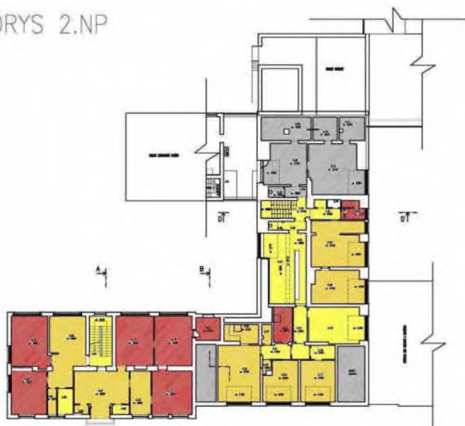
Obr. 4 : Rozdělení budovy podle vnitřní teploty – 2. NP a 3. NP
