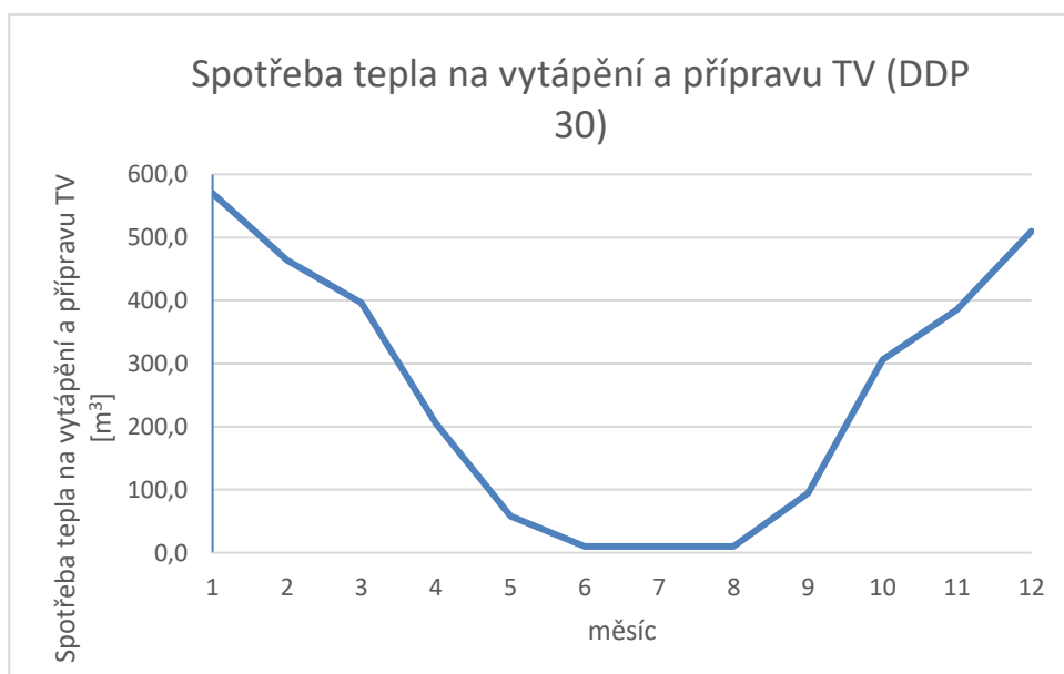
Obr. 3: Předpokládaná spotřeba zemního plynu na vytápění a přípravu TV zateplené budovy ZZS v nemocnici v Novém Bydžově
