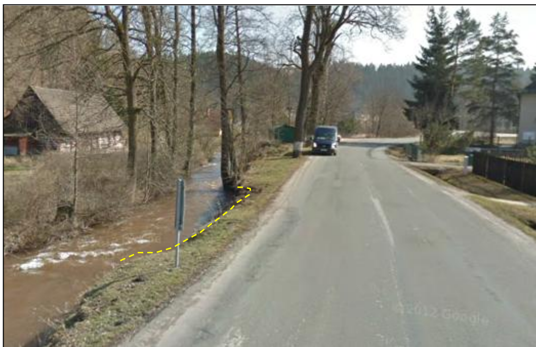
Foto 6: stav břehu před povodní - žlutě je naznačen ji dříve vyerodovaný záliv k hlavní poruše došlo vířením vody za kmenem vystupujícího stromu
