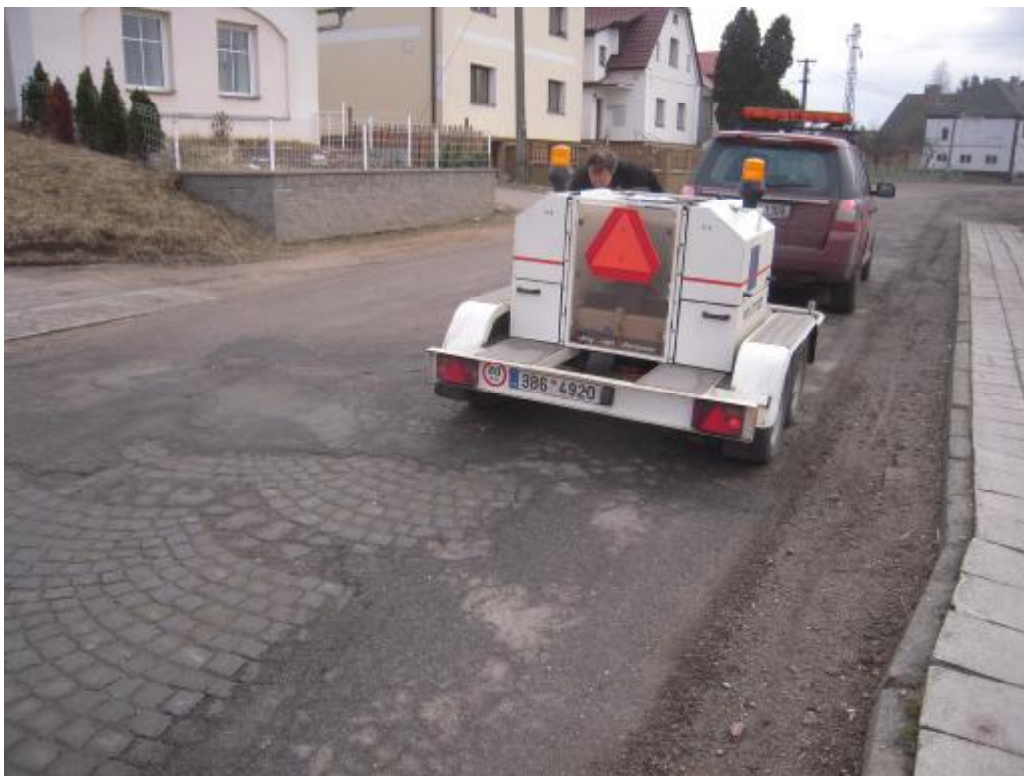
F01 – začátek úseku v km 21,805 (konec dlažby) ; deflektometr FWD
