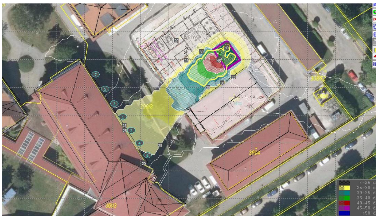
Obr. č. 7 - vykreslení izofonových pásem výška 4 m
