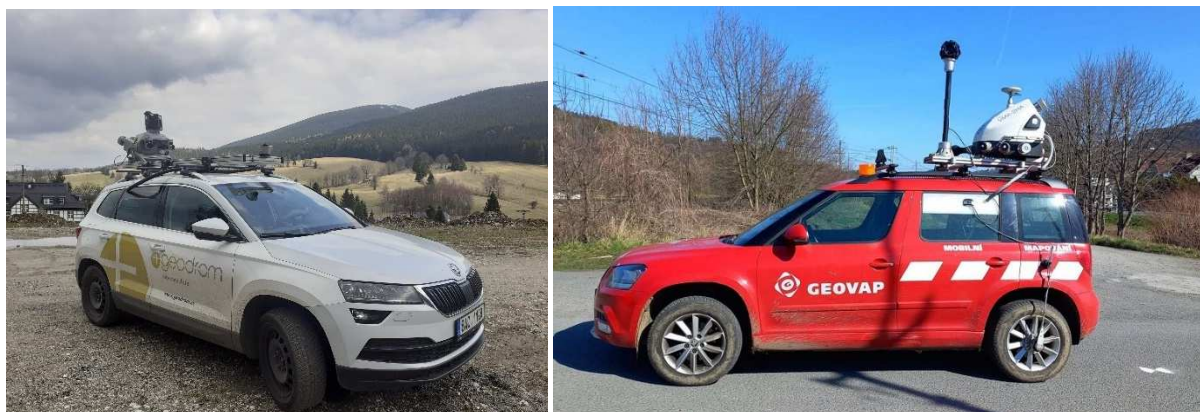
Obrázek 15: Mobilní mapovací vozidla (GEODROM s. r. o., GEOVAP, spol. s r. o)
