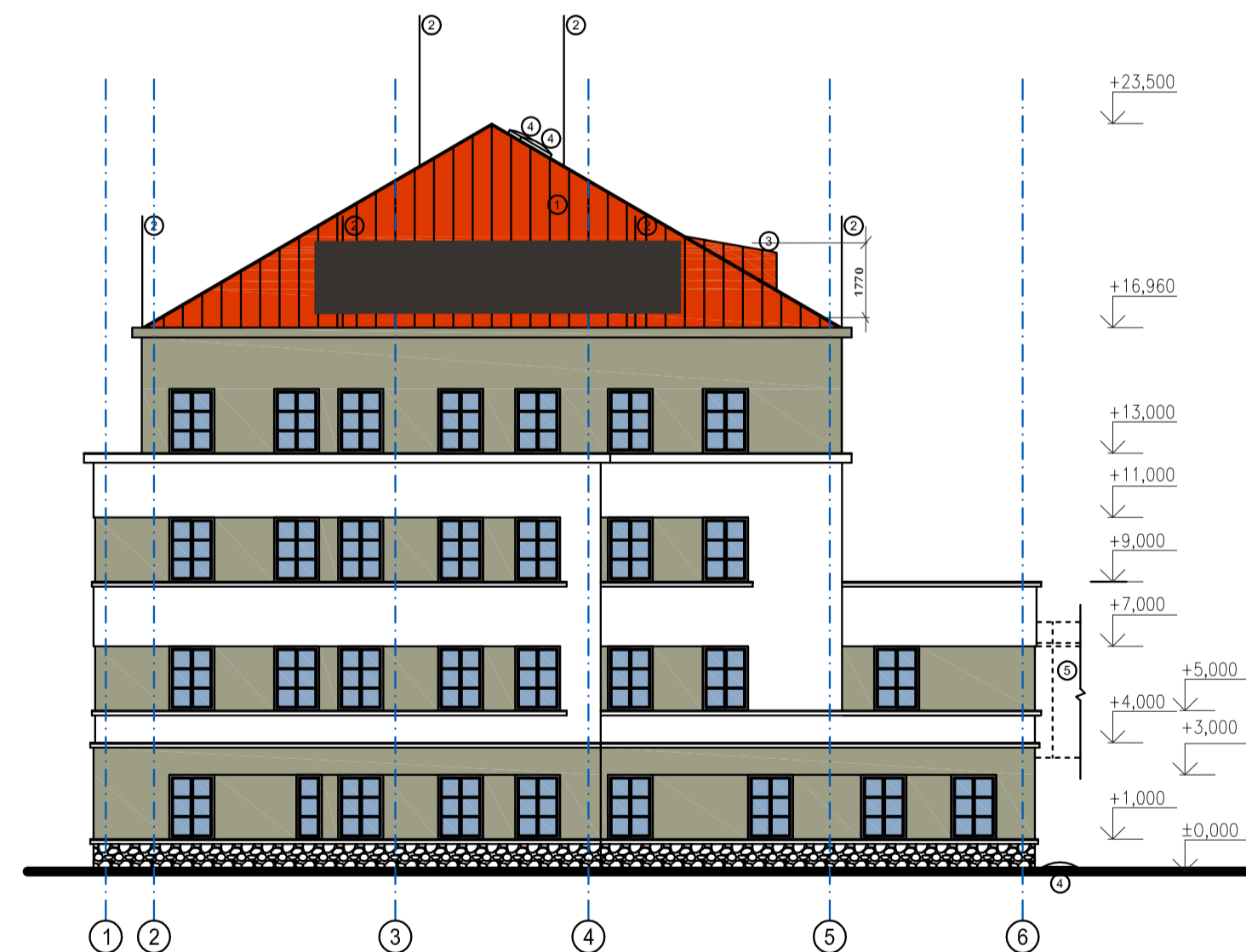
POHLED JIHOVÝCHODNÍ 18 ks panelů IBC 420 Wp o výkonu 7,56 kWp
