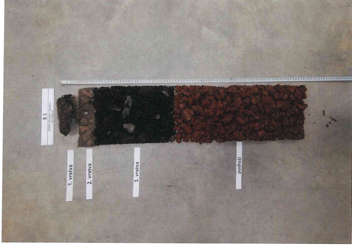
Foto č. 8 – Detail kopané sondy S 3
