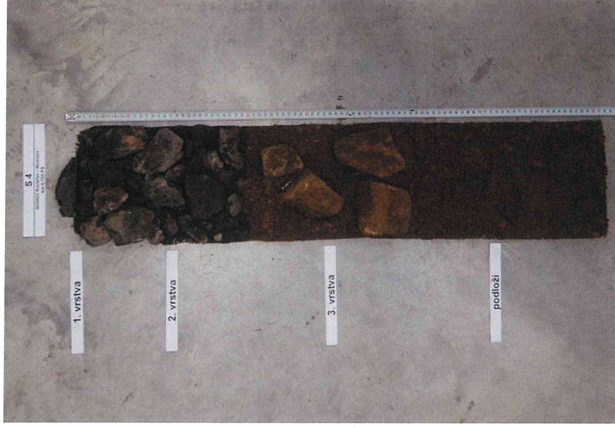
Foto č. 10 – Detail kopané sondy S 4
