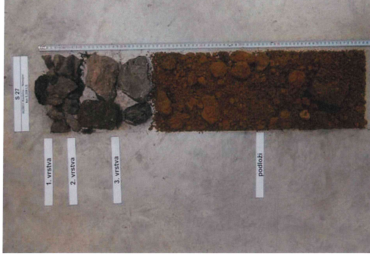
Foto č. 64 – Detail kopané sondy S 27
