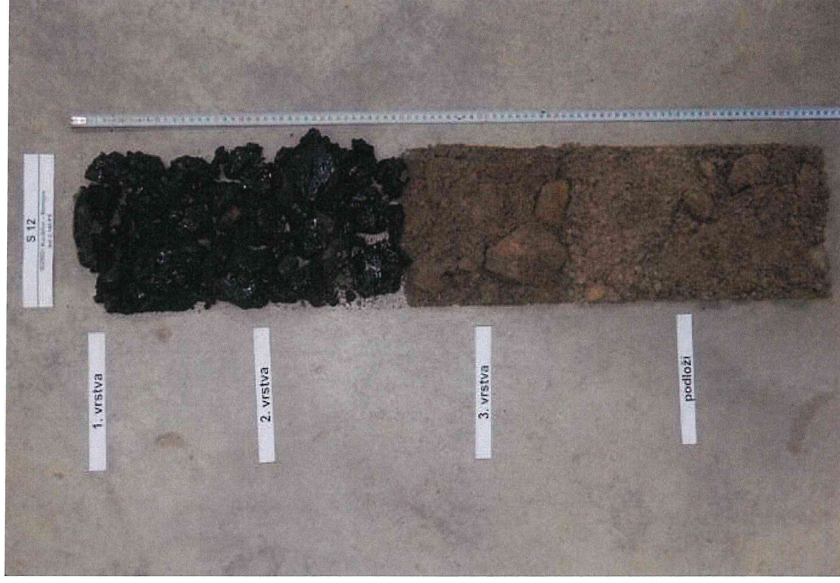
Foto č. 28 – Detail kopané sondy S 12
