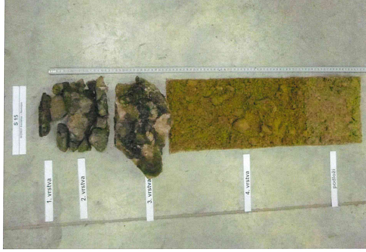
Foto č. 36 – Detail kopané sondy S 15
