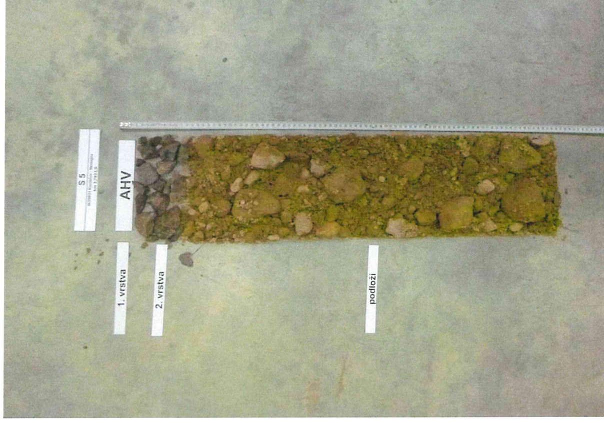
Foto č. 50 – Detail vrtané sondy VS 5
