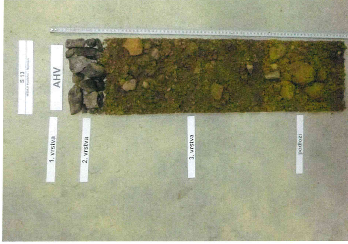
Foto č. 30 – Detail kopané sondy S 13
