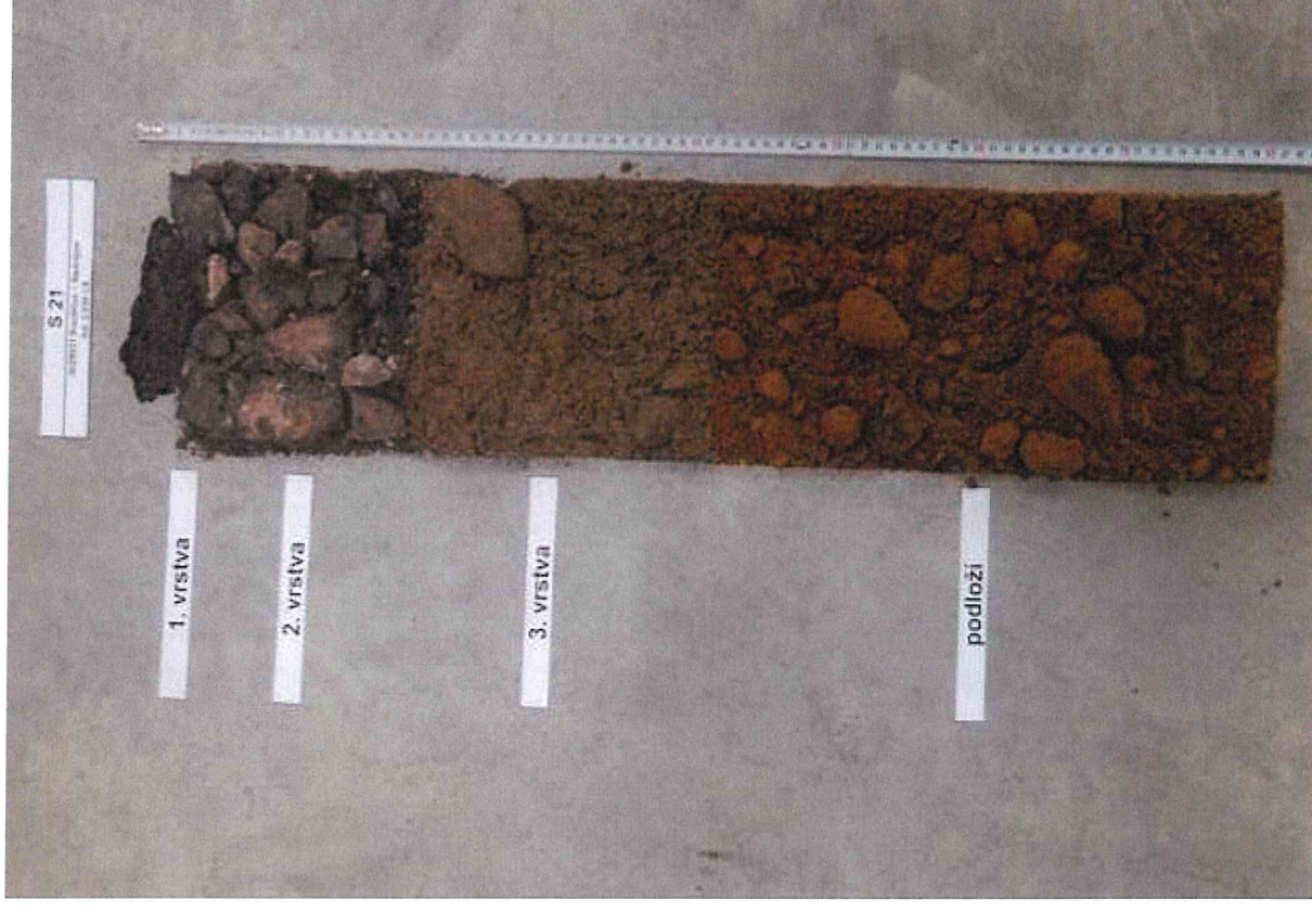
Foto č. 52 – Detail kopané sondy S 21
