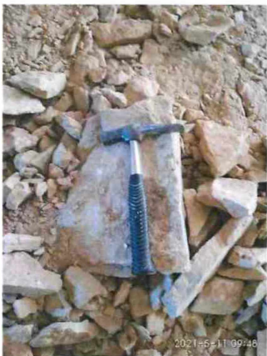
Obr. 3 – fragmentace výkopku – kamenitá sypanina
