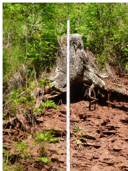
Rozvolnění horninového masivu kořeny stromů
