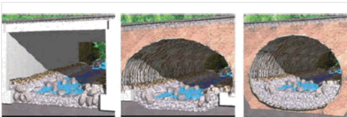
Obr. 10.40 Modely mostu a propustků s balvanitou úpravou dna
