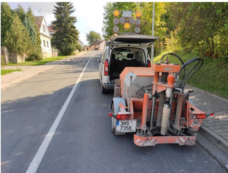
Provádění jádrového vývrtu – č.7
