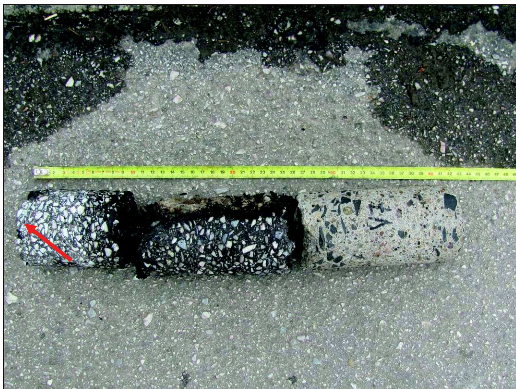
Foto 5: Detail odebraného vývrtu V7. Šípkou vyznačen horní líc (vozovka).
