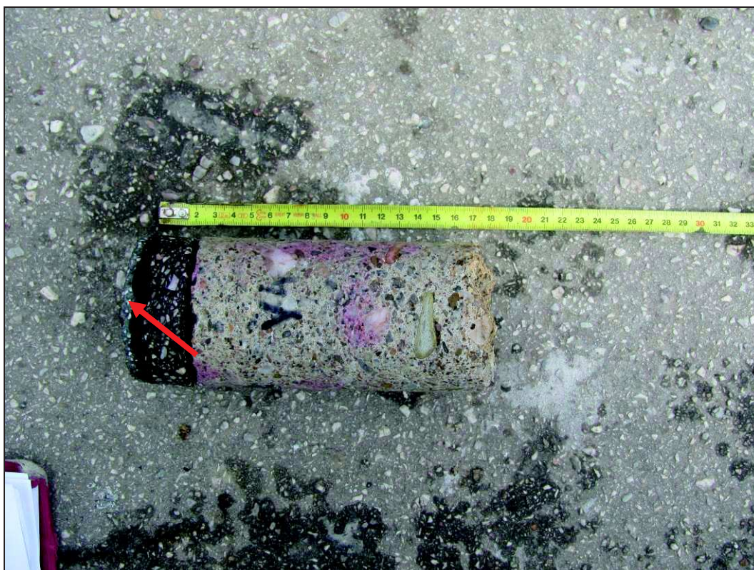
Foto 2: Detail odebraného vývrtu V4. Šípkou vyznačen horní líc (chodník).
