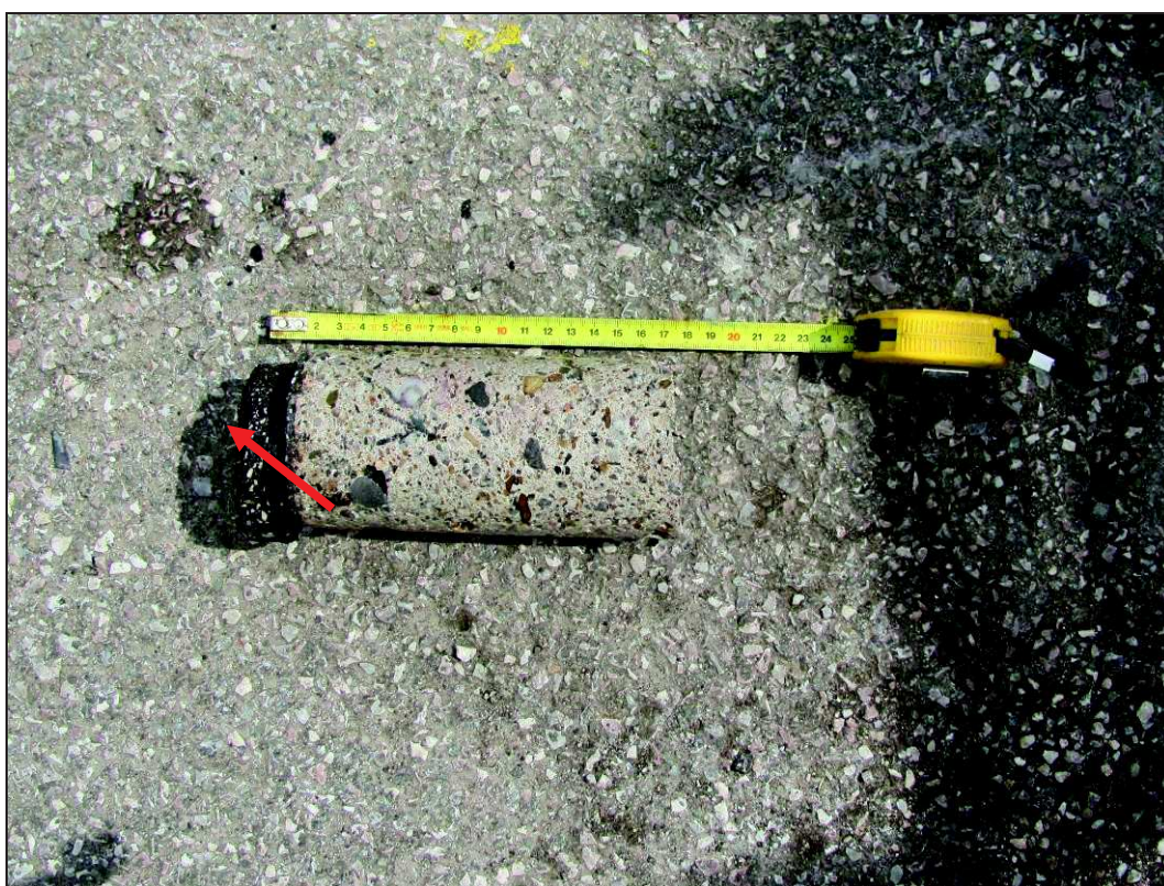
Foto 4: Detail odebraného vývrtu V6. Šipkou vyznačen horní líc (chodník).
