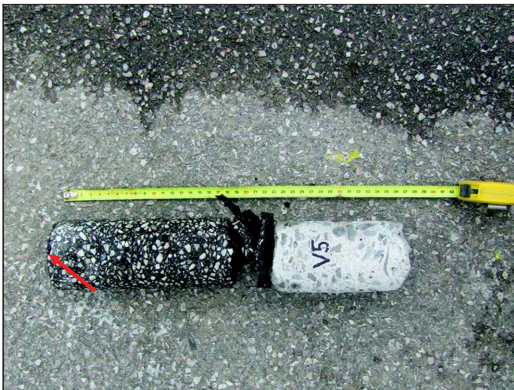
Foto 3: Detail odebraného vývrtu V5. Šipkou vyznačen horní líc (vozovka).
