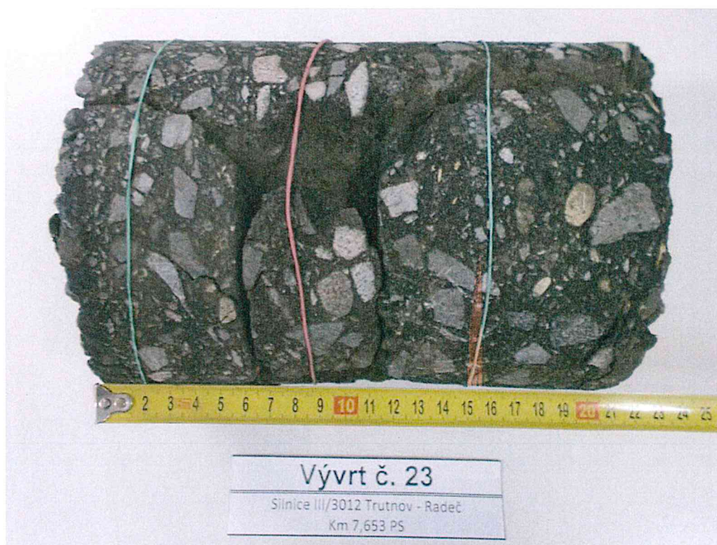
Foto č. 28 – Detail vývrtu č. 23
