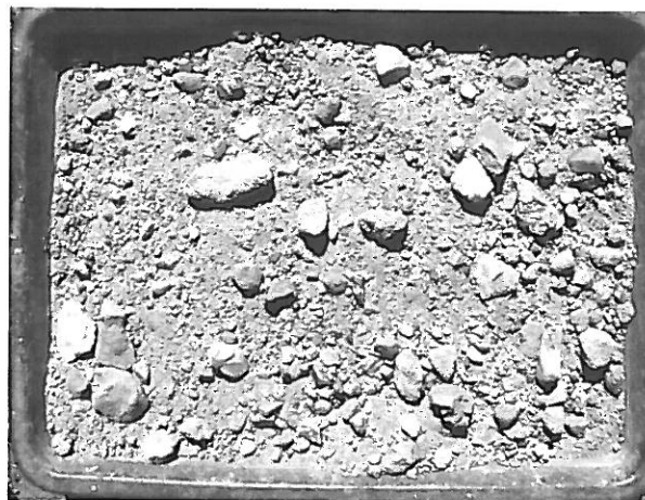
dtto: písčito-šterková frakce vzorku po odstranění frakce prachovito-jílové.
