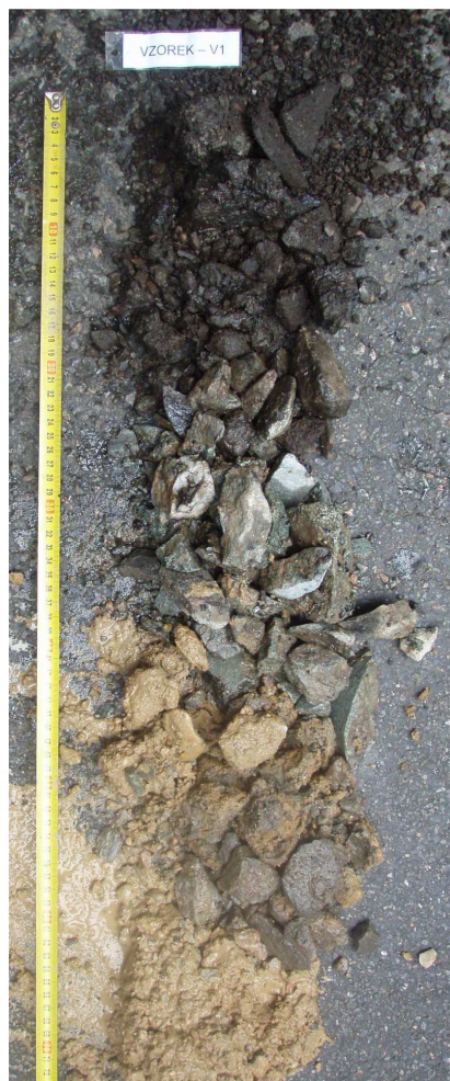
Obr. 1 - Jádro vývrtu Vzorek – V1 (in situ).
