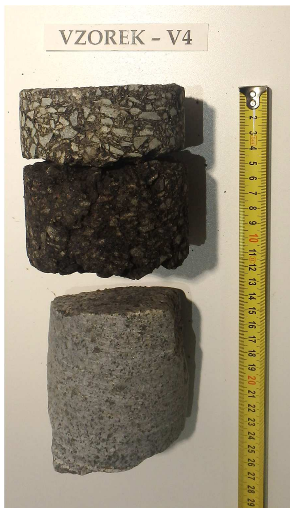
Obr. 8 - Jádru vývrtu Vzorek – V4 (laboratoř).
