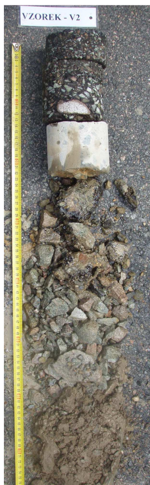
Obr. 3 - Jádro vývrtu Vzorek – V2 (in situ).
