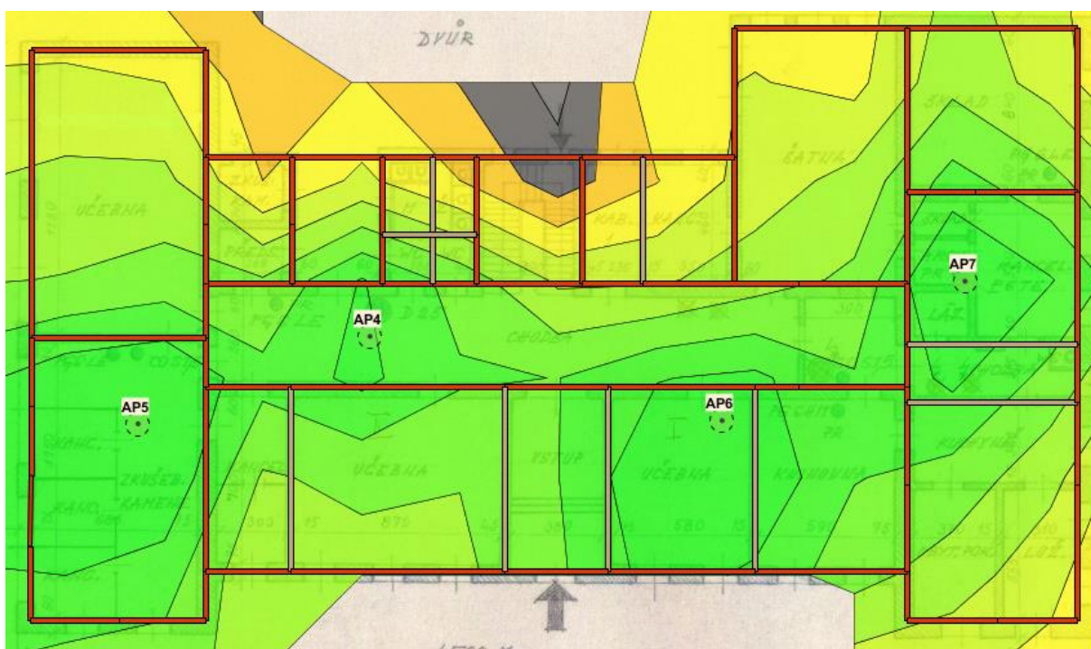
Obr. 10 Hlavní budova – 2.NP – síla signálu RSSI pro 5GHz
