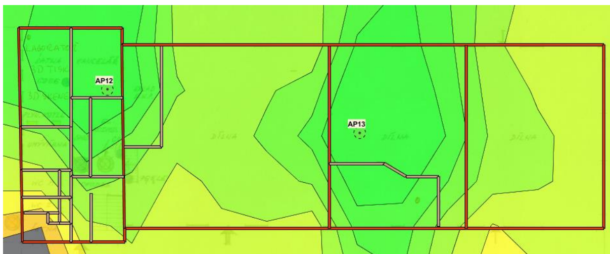
Obr. 13 Dílny – 1.NP – síla signálu RSSI pro 2,4GHz
