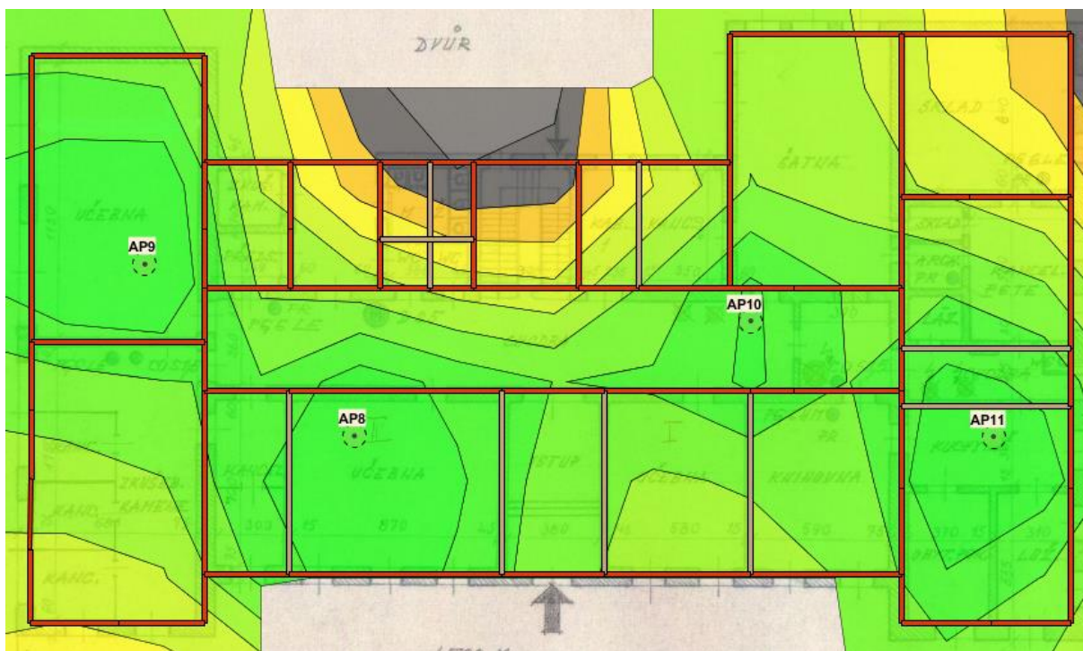
Obr. 12 Hlavní budova – 3.NP – síla signálu RSSI pro 5GHz
