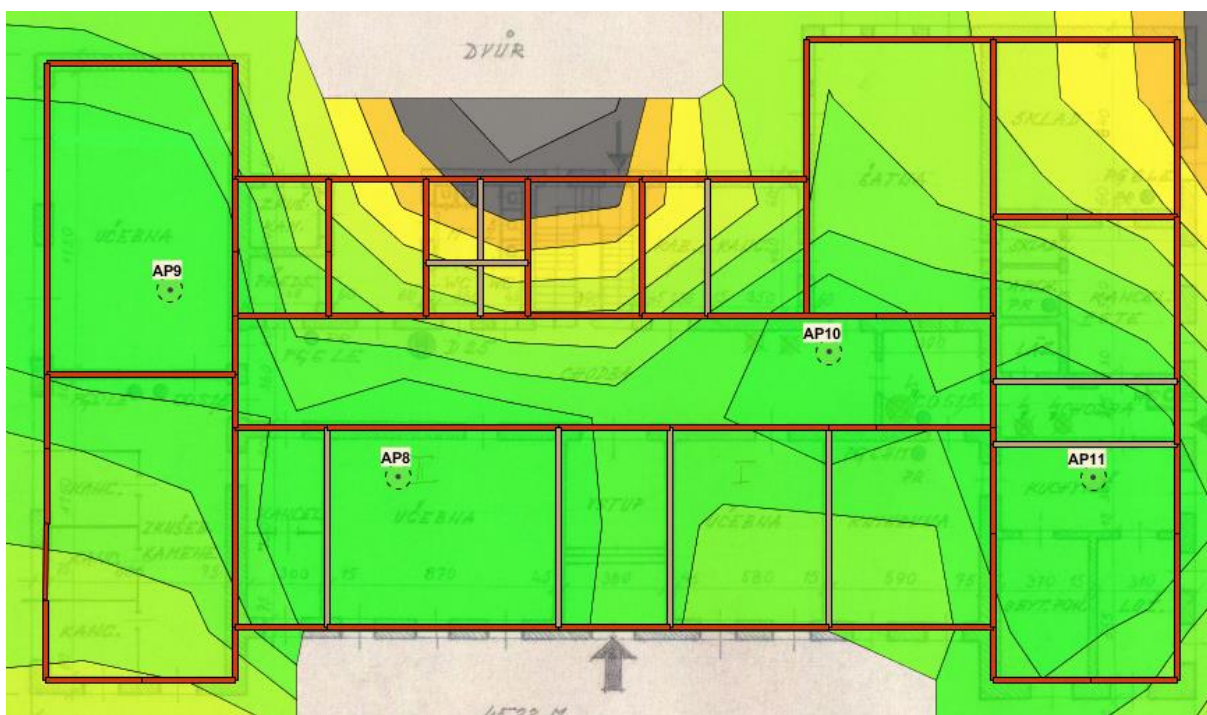
Obr. 11 Hlavní budova – 3.NP – síla signálu RSSI pro 2,4GHz
