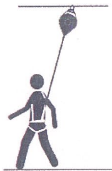
Zajišťovací systém proti pádu se zatahovacím zachycovačem pádu
