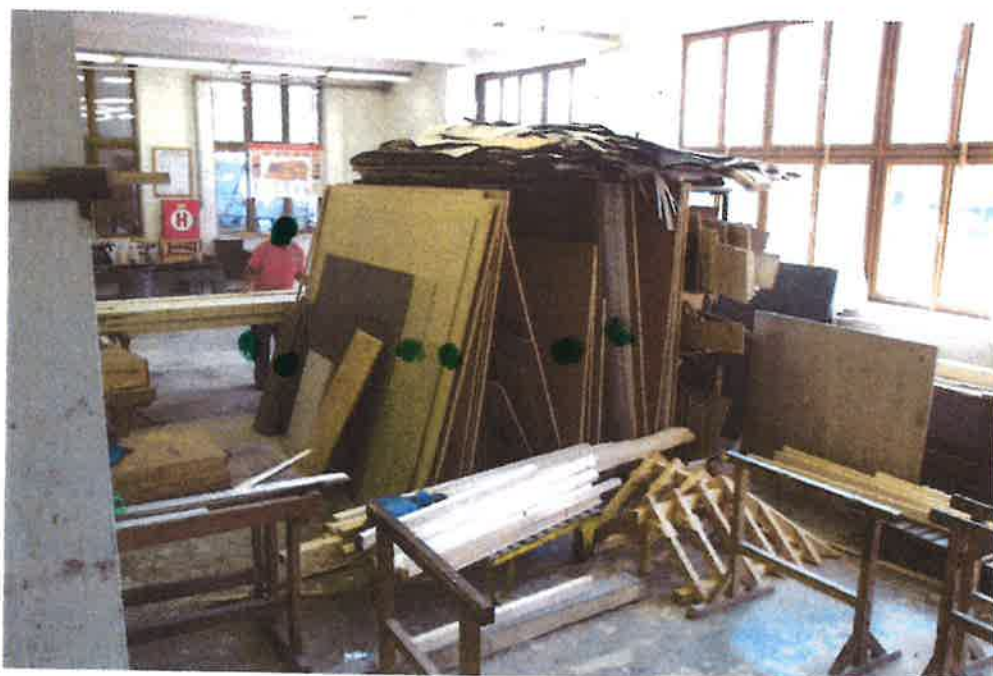
Nevhodný prostor pro uskladnění deskového materiálu
