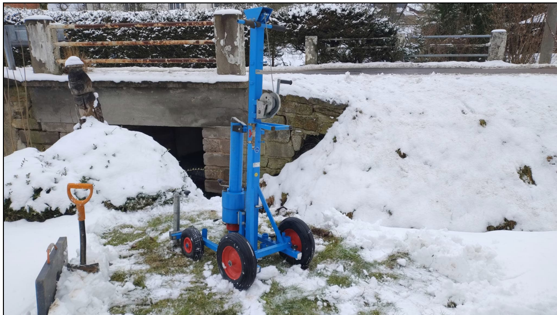
Obr. 3: Realizace sondy dynamické penetrace DP1 (resp. zaražené sondy)
