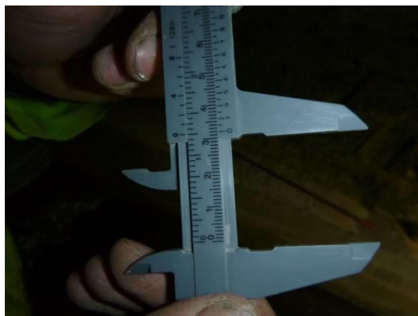
Po definovaném návrtu se měří hloubka vrtu a stanovuje se pevnost dle kalibračních vztahů.
