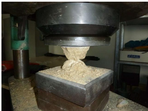
Pohled na vývrt po destruktivní zkoušce.
