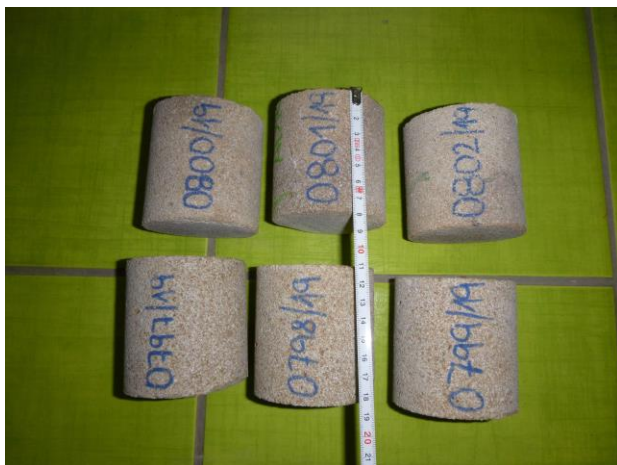
Pohled na upravené vývrty před zkouškou.
