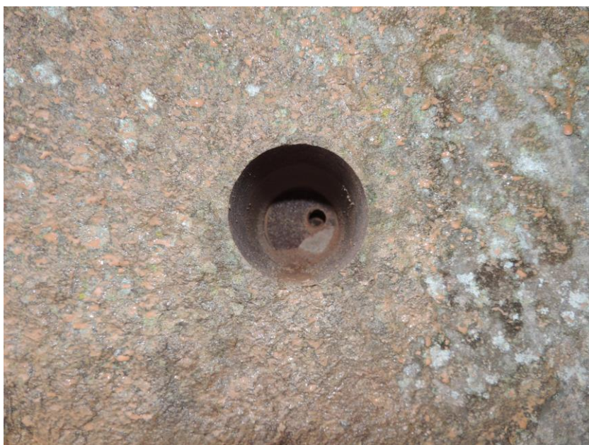
Pohled do otvoru po odběru zkušebního vzorku
