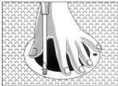
Následně je pomocí šroubů upevněna příruba
