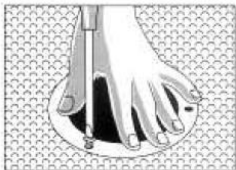
Následně je pomocí šroubů upevněna příruba
