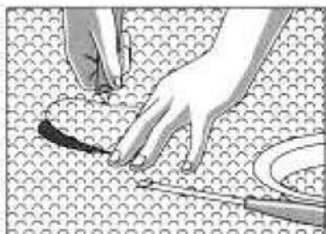
Podél vnitřní strany vpusti je vyříznut otvor do krytiny a horkým vzduchem vytvarován dovnitř vpusti
