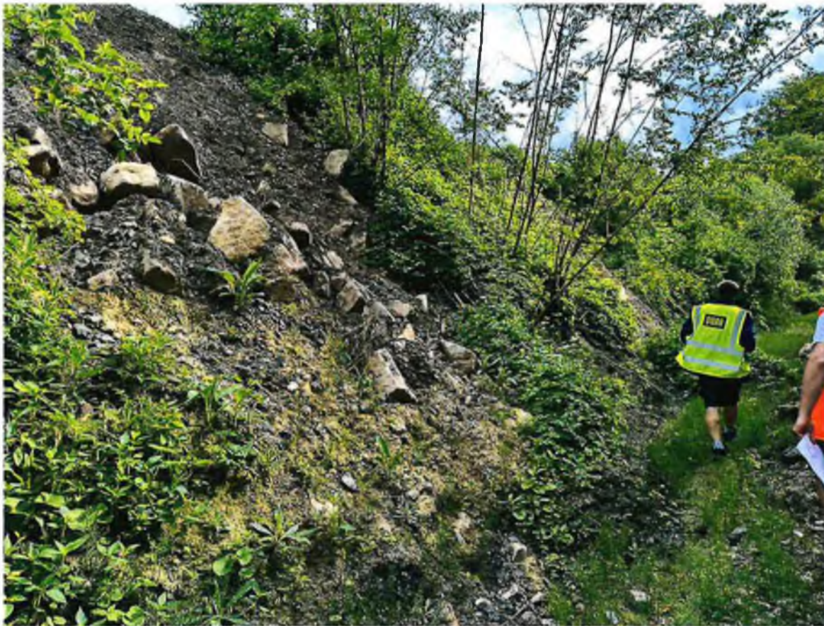
Obr. 2 Snímek balvanů vhodných pro vytvoření záhozové patky z LK.
