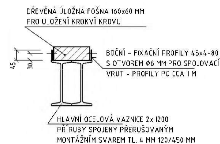
DETAIL ŘEŠENÍ HLAVNÍ OCELOVÉ VAZNICE 1:10
