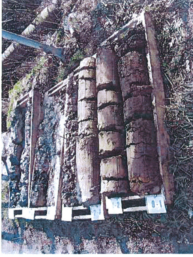
Souvislý vrtný výnos na J1 (0,00 - 8,00 m) - detail svrchních vrstev
