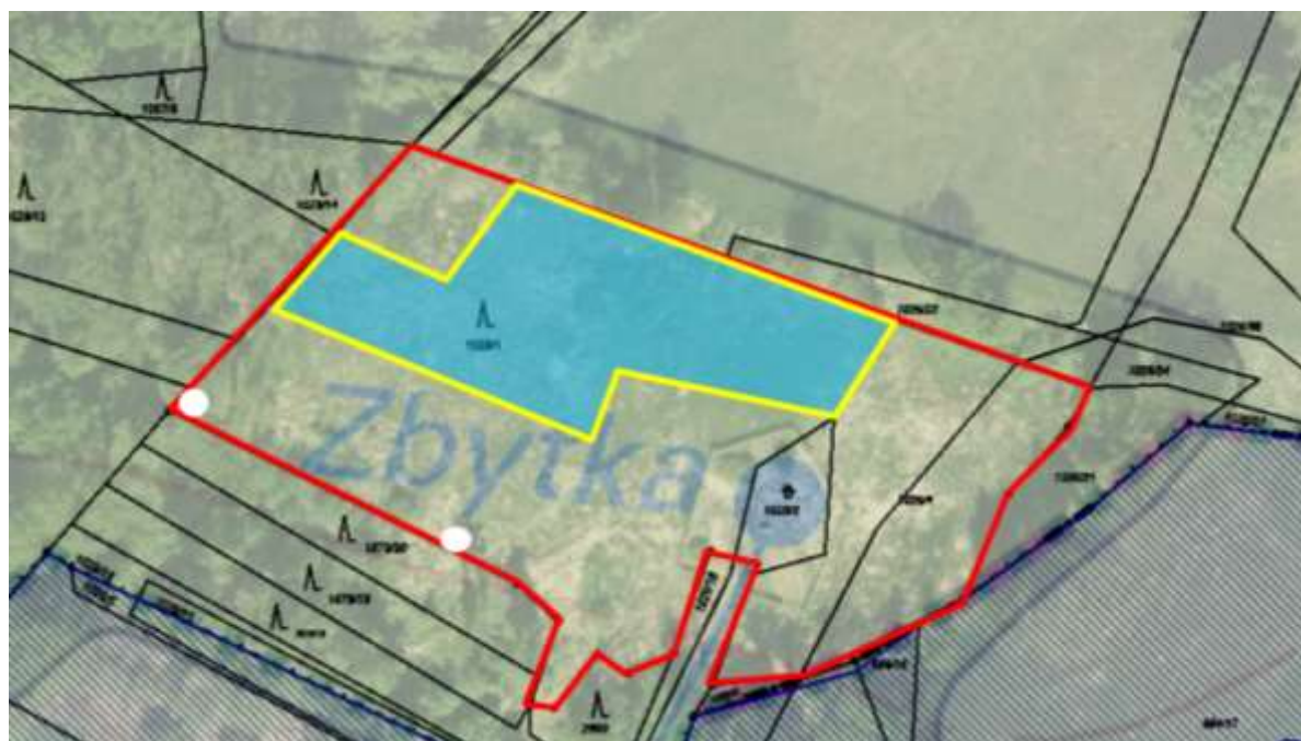
Příloha č. 2: Schematické znázornění: červeně je ohraničena plocha k bránování, modře plocha k odstranění vrstvy biomasy a bíle jsou vyznačeny plochy pro deponii biomasy
