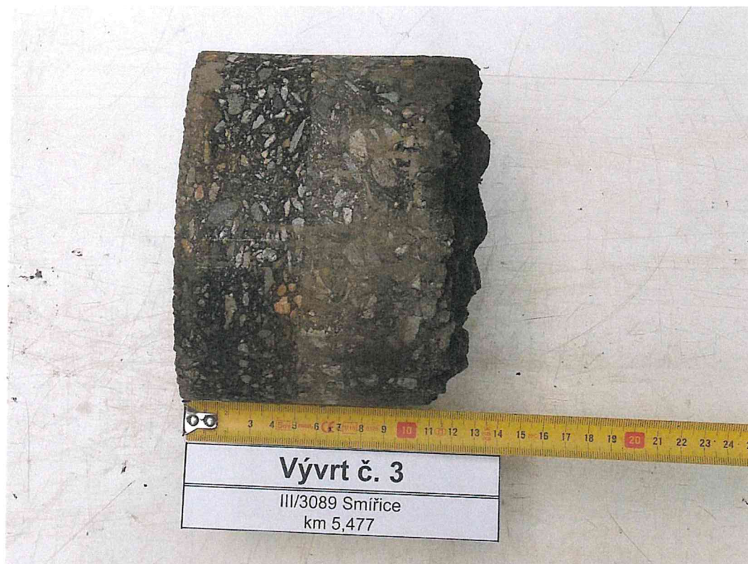
Foto č. 3 – Detail vývrtu č. 3
